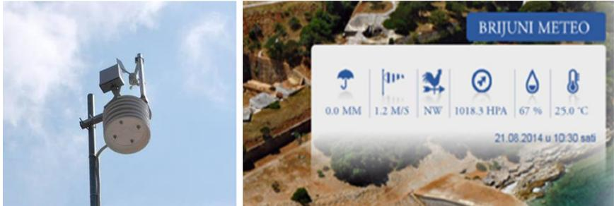
Meteorološka stanica u jedinom istarskom Nacionalnom parku mjeri temperaturu zraka, relativnu vlažnost, tlak zraka, smjer i brzinu vjetra te količinu kiše. Aktiviranjem meteo postaje omogućeno je i dugorono praćenje vremenskih prilika i klimatskih promjena na Brijunima, kao i uspoređivanje podataka s obližnjim obalnim mjestima gdje već ima nekoliko meteoroloških postaja.
